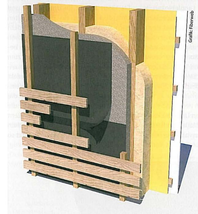
Höchstmögliche UV-Belastung an Holzfassade mit sichtbarer schwarzer Fassadenbahn
