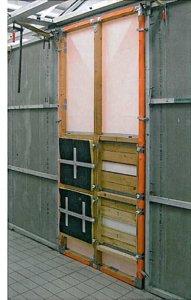
Beim Schlagregentest wird herabfallender künstlicher Regen mit einem starken Ventilator gegen eine Versuchsfläche geschleudert. Versuchsaufbau: USB freihängend, auf Schalung und auf Wärmedämmung
