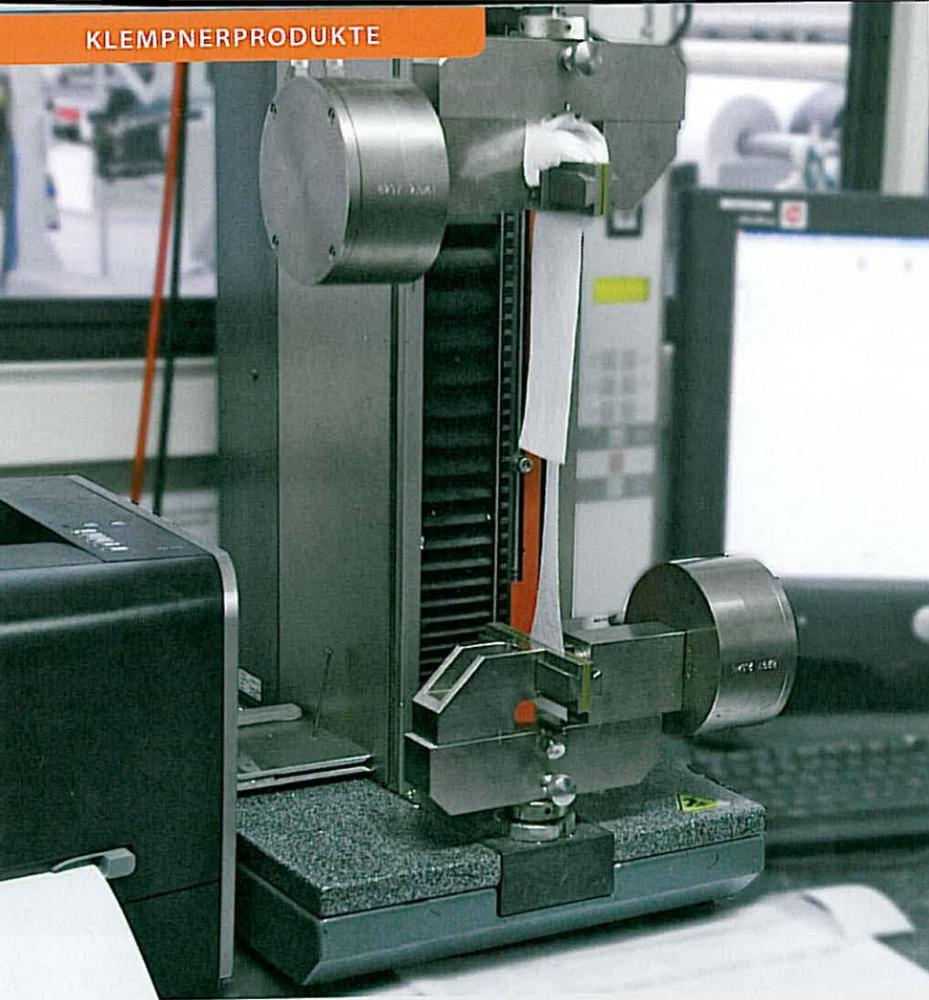
Die Bahnen-Festigkeit wird in einem Reißversuch ermittelt.
